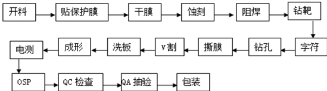
图 4.2.3-3 铝基板多层高密线路板工艺流程
