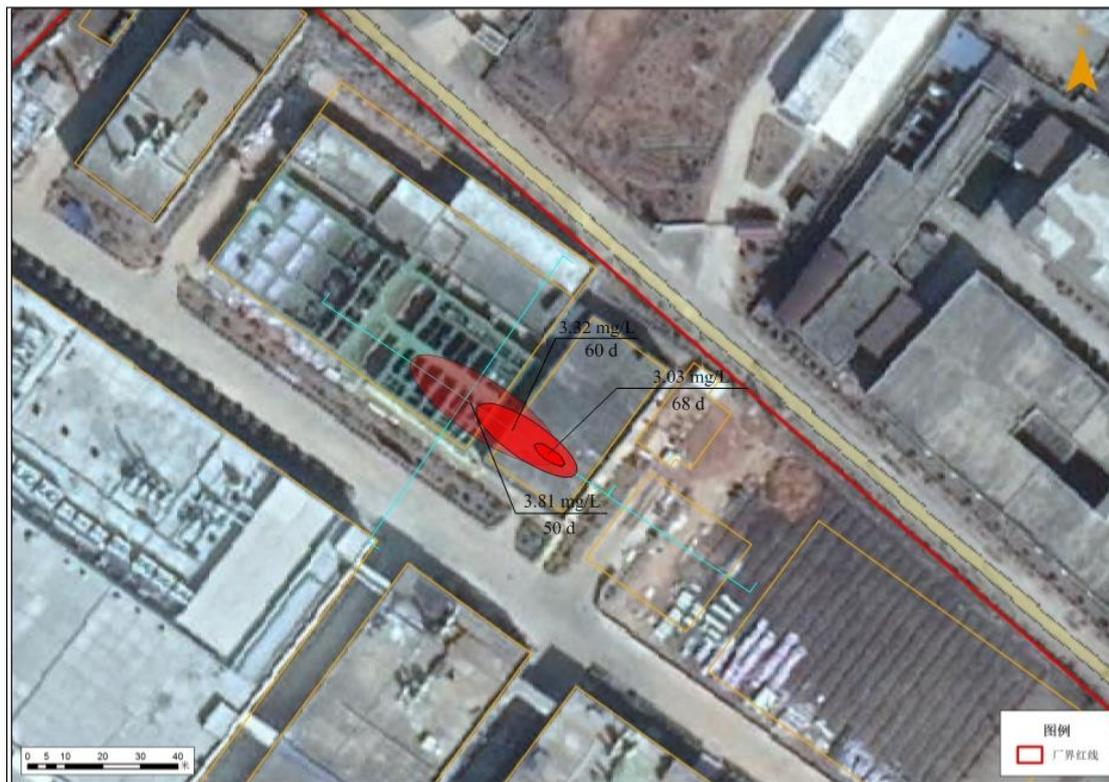
图 5-2-4 事故状况下 COD 在含水层中的污染晕预测图
